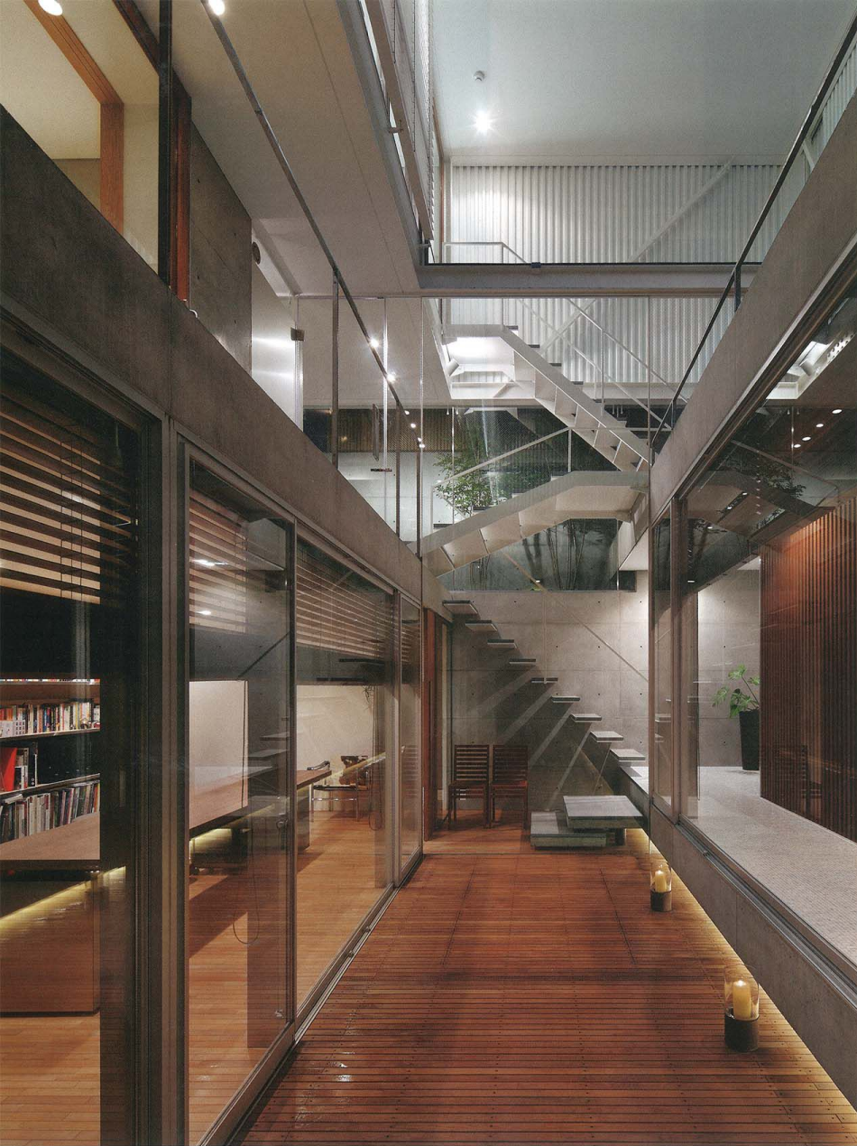
地下の中庭から南側の階段室を見る。階段室は、地下1階から上方ヘイナミックに伸び、強調された遠近感が空間のボリュームを際立たせている。4つの階段は、下から順に勾配25度、42度、24度、40度と変化した5つのレベルをつなぐ。階段の地下左手の書斎は、幅2970mmピッチで並ぶガラス引き戸(H2160mm)で中庭につながる。右手のバスルームや洗面室とも連続性を持たせ、最もプライベートな場所にしつらえた。階段室は大ガラス(W1980mm×H4850mm)で中庭と仕切り、透過性を生かして視覚的に開放しながら物理的に閉じ、空間の独立性を共存させている。左手の上層は和室の前の廊下。右手の上層はルーフトデッキ
